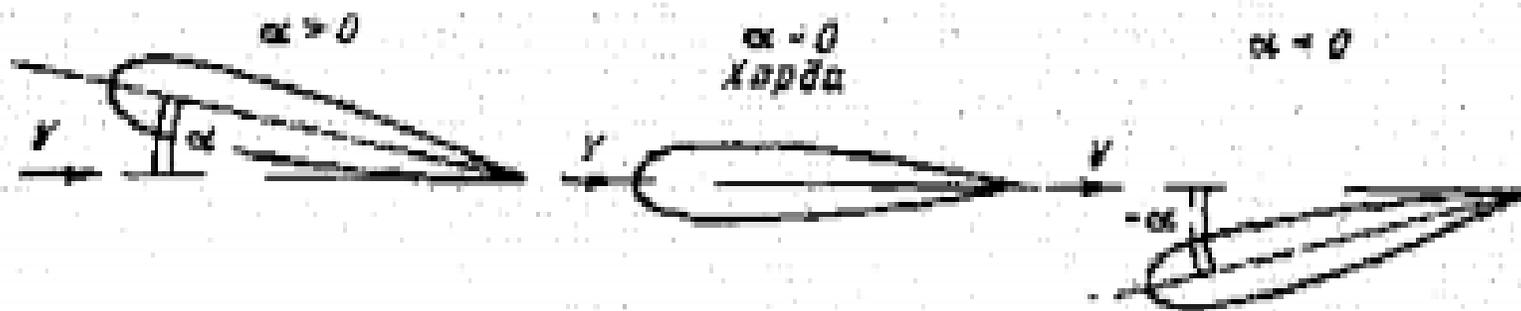
Рис. 1.2. Угол атаки крыла.
